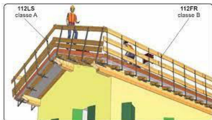
Esempi di parapetti di protezione
